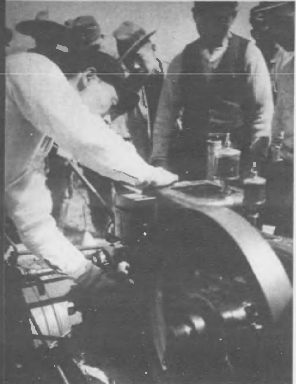
試運転——モーターをかけたとき、ドッドと速い運動がはじまつた。このトラクターは全く日本のものなので、その構造は左右兩輪をもつた鐵骨車輛に三馬力程度の發動機を載せ後部の爪車を旋轉しながら自動的に進行する。トラクターは馬牛(耕)に比べて殆んど十倍の競争をあげることができる——耕耘の比較實績
