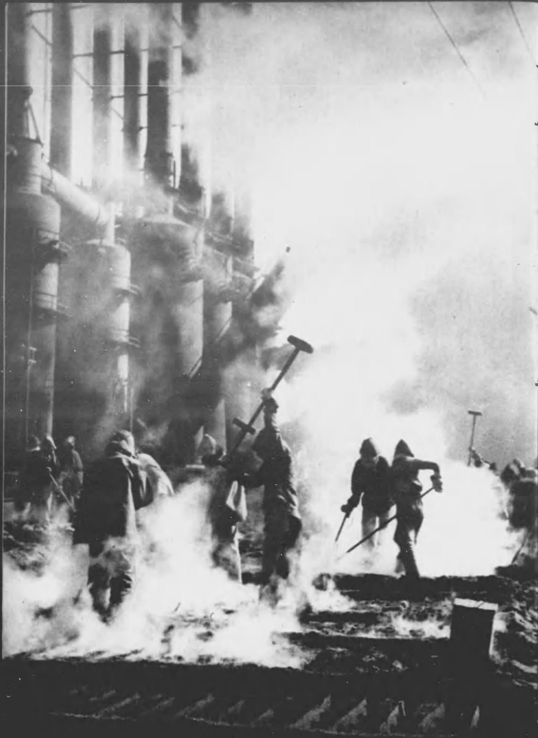
⇐ 出鉄した熔鉄を砂型に流して むと砂型鉄が出来る
