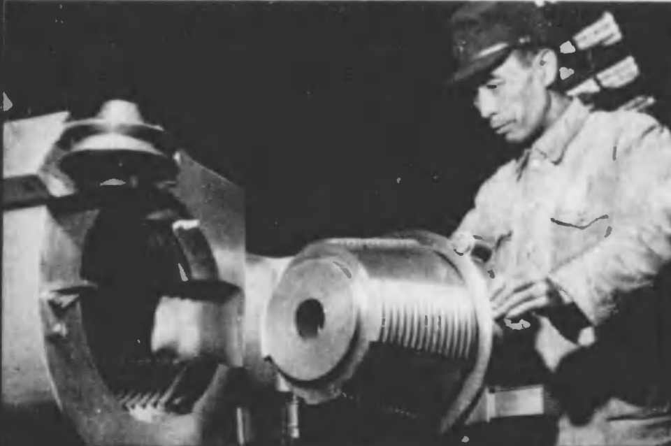
いよいよ砲身の出来上り、閉鎖機が取り付けられると立派に一人前、あとはゆつたりと砲架に腰を落ち着けるばかりだ
