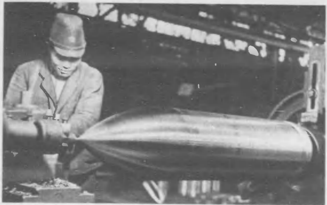
早い速度で旋回し ながら徹甲弾の 外面削り。波線 の美しい歪が なみをきいて 青を帯びて 目に浮かぶ
