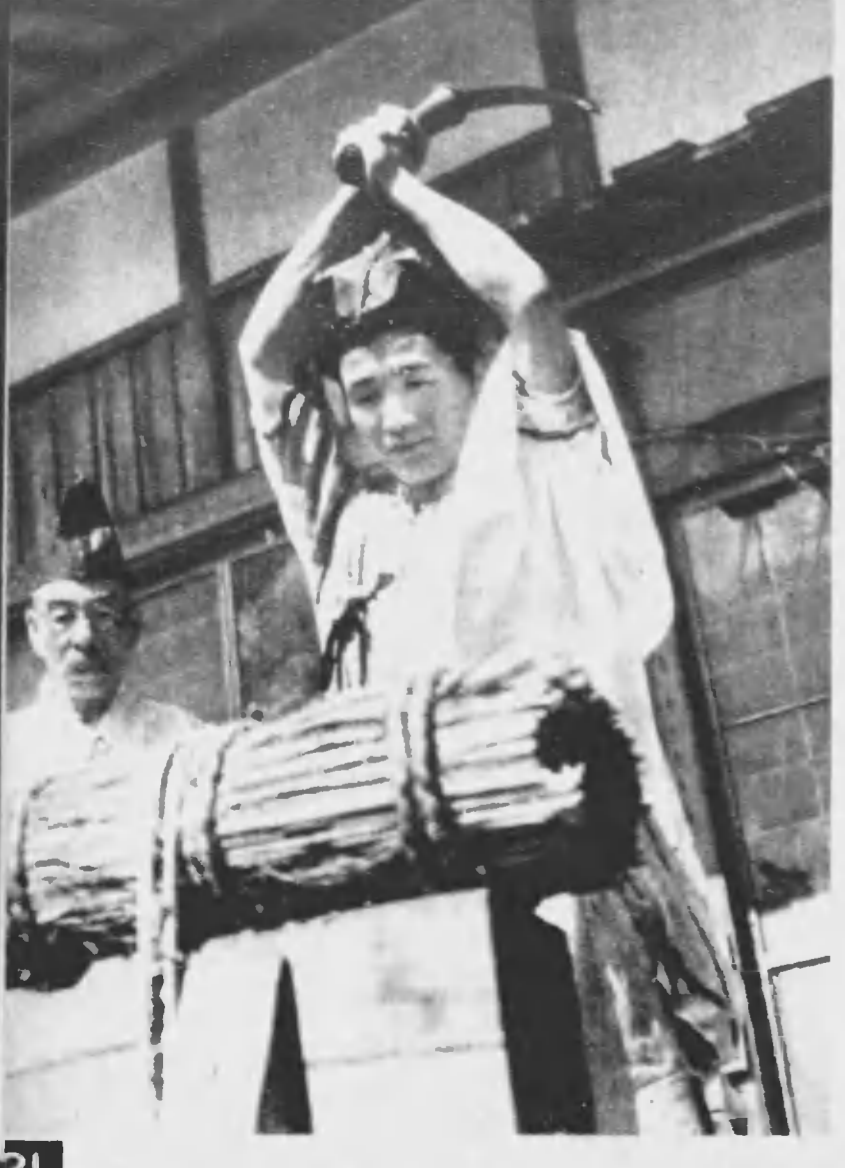
◁ 刀匠の丹精こゝに決する焼入の場。堅傳の湯加減にジユツと定込み次の瞬間白煙があがる。
