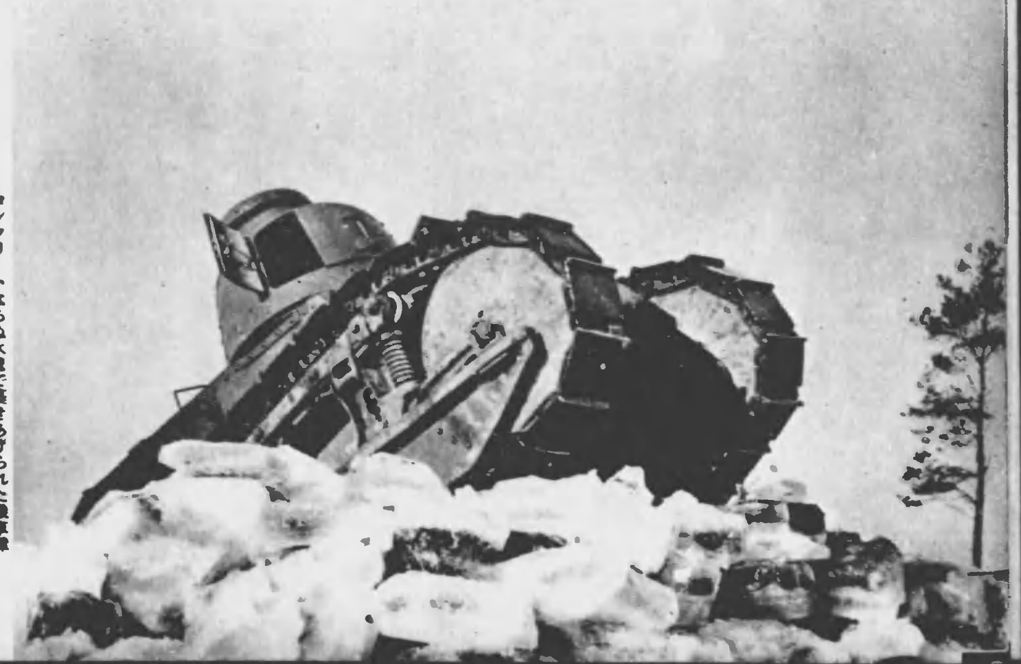
⇨ コンクリートならぬ氷塊で築きあげられた戦車障壁、ジークフリッドラインやマチノラインの近代陣壁に劣らず如何なる戦車も喰ひとめられる
