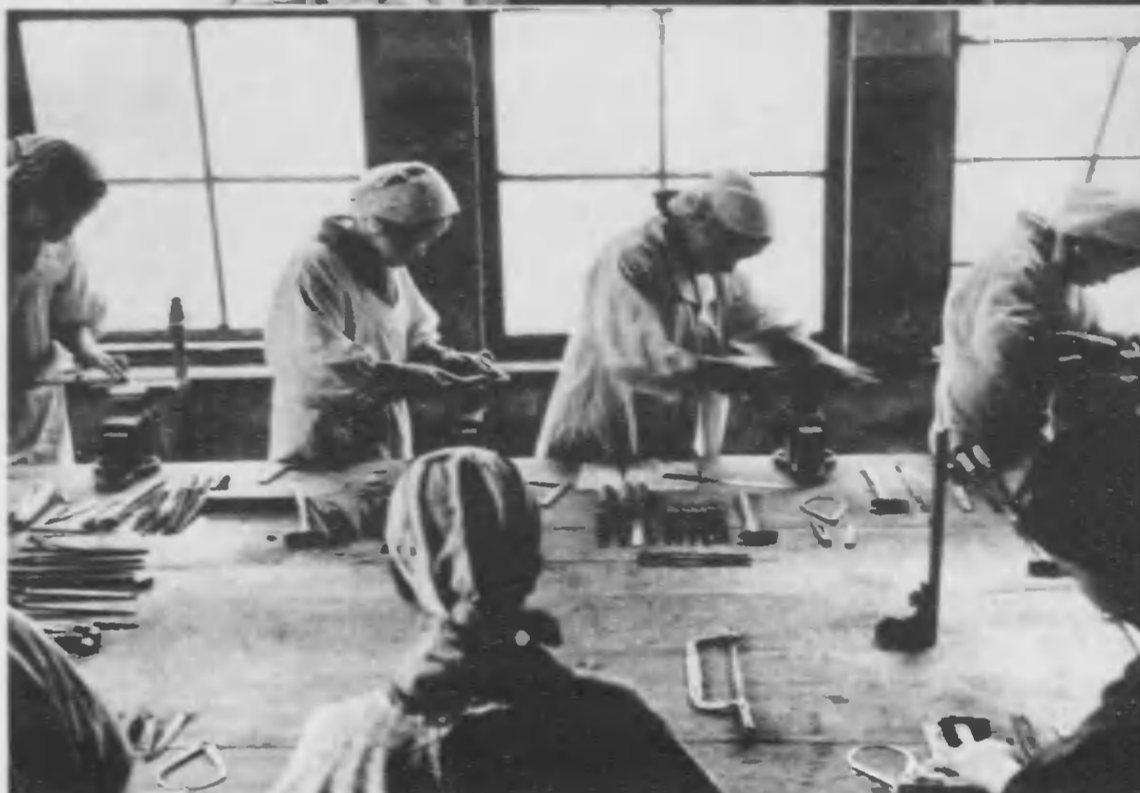
仕上工はヤスリから、細いやさしい指先は仕上げに繊細さがある。開所一ヶ月外徑コンパス使用で平行面の誤差は僅か百分ノ二ミリ程度の上達ぶりである。
