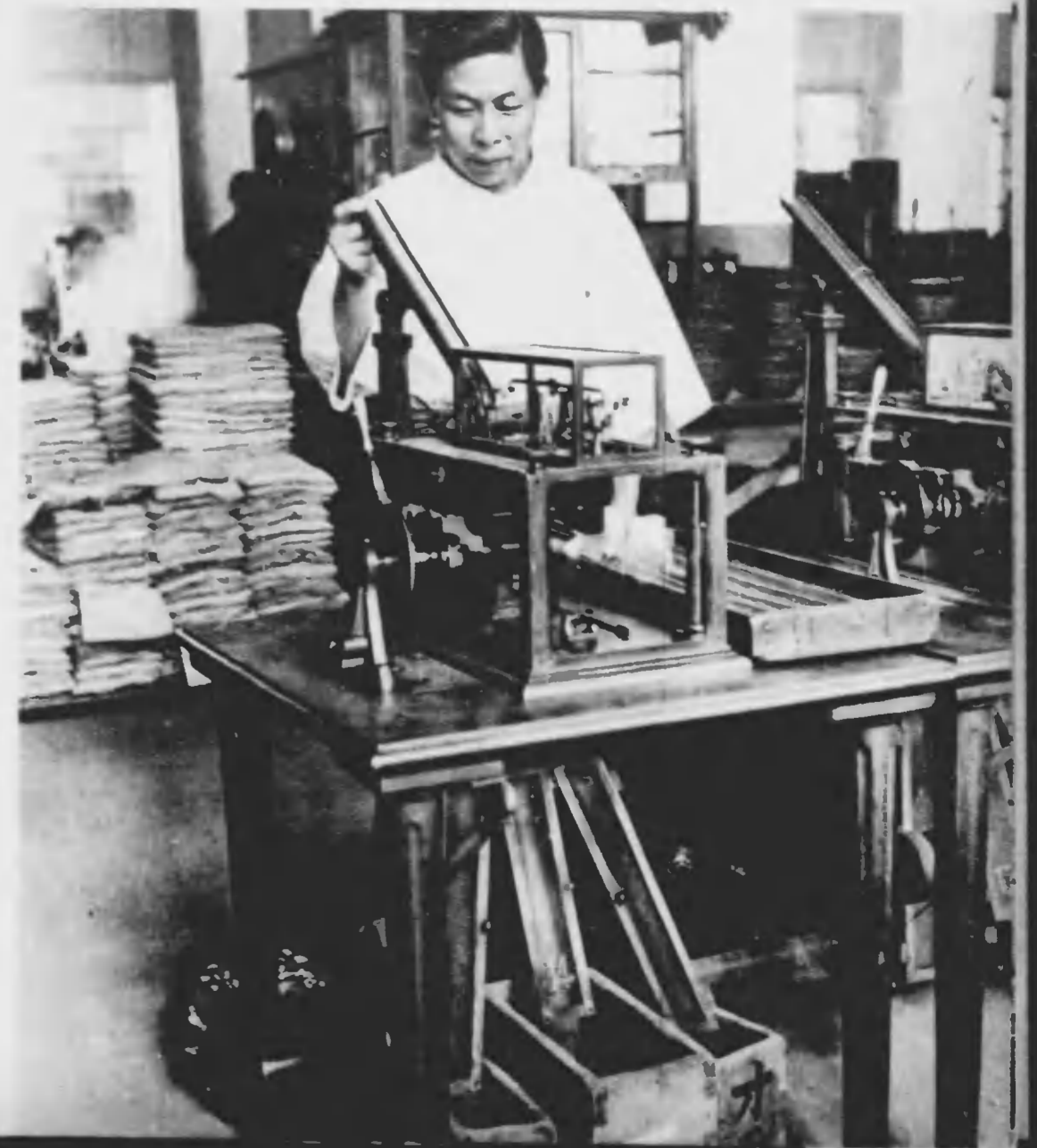
計量 十圓金貨の重きは八、三 三三瓦、二十圓金貨は一 六、六六六瓦、これにい さ、かの違ひもあつてはな らぬ。 自動天秤はわずかに重す ぎるもの、軽すぎるものを も自動的に除外する。 押印 形、量二つの検査に合格 した金貨は最後に両面に文 字模様を押し印され、こゝに 完全な金貨となる。
