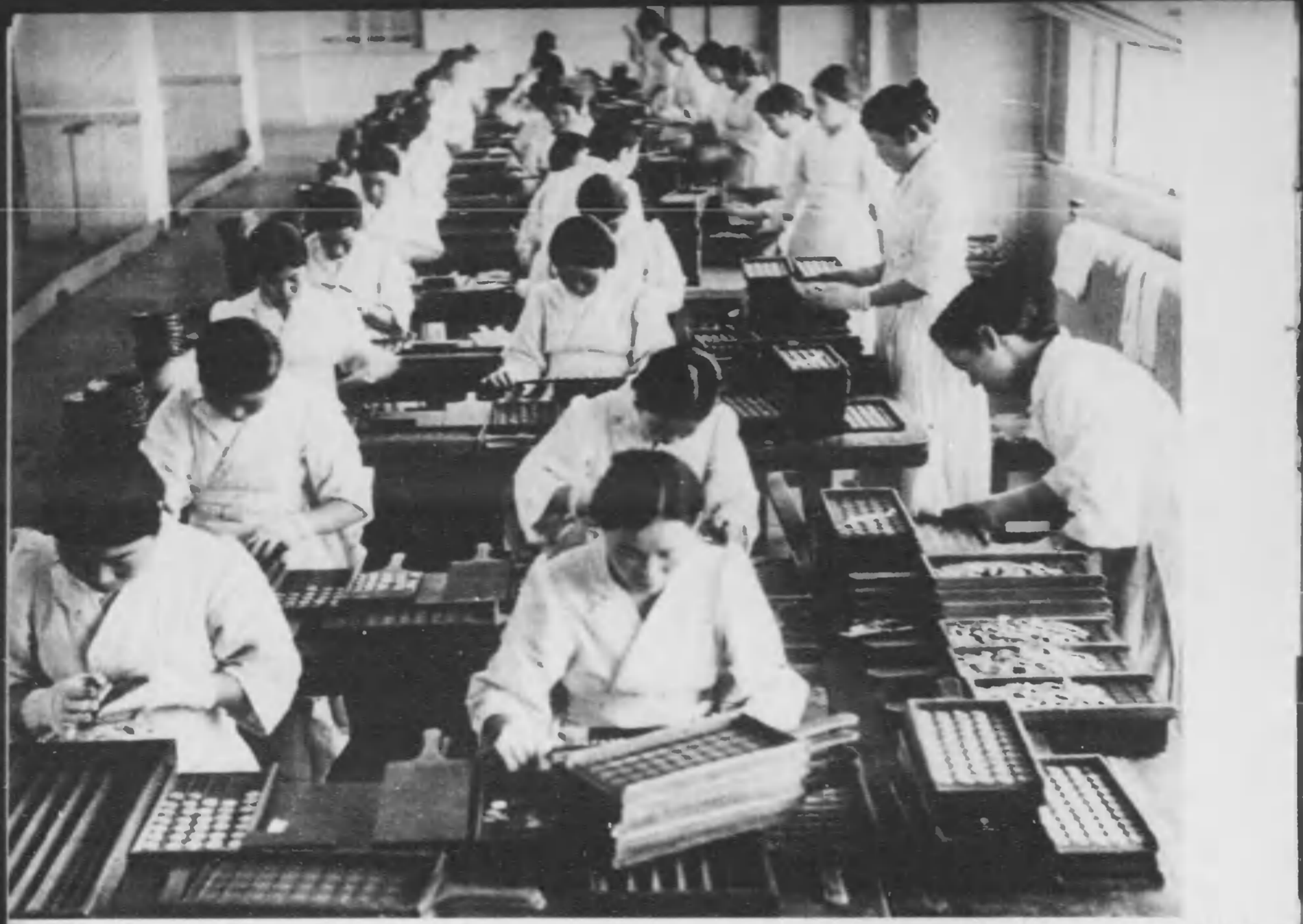
検査 完全な形を備へた金貨は も一度最後の厳密な検査を うけて、 包装 五十個づつ一包みに包装 され、いよいよ黄金の偉力 を發揮する。
