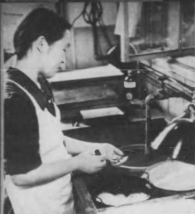
これを最後の水洗機にうつしてやばらかい毛ばけで一つ一つ丁寧に上げてゆく。
