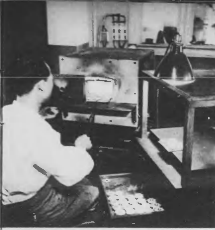
電気で七寶をきき上げ、更に特大機で備があるかないかを確かめ、合格すればもう一べん今度は手焼きをする。
