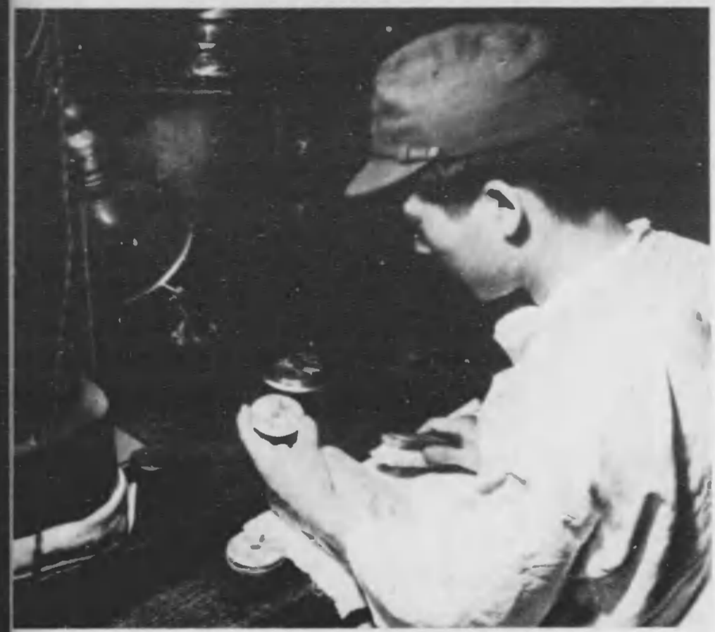
製造工程を具体的に説明すると、先づ型押しとして浮きのやうに機械で彫して勲章のかたちを浮きとらせる。
