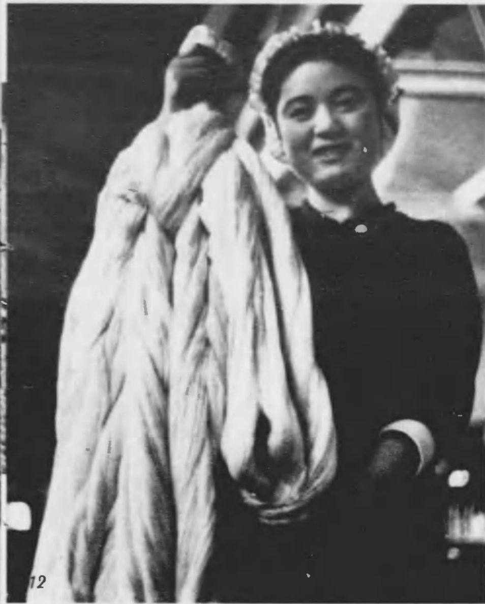
12 練糸 原糸は二本揃へ合は せ双糸とし、この双糸を瓦斯機 でケバをとり、光澤を出し、 総取り機にかけ、一定の長さの 綿糸とする
